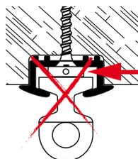
Durch die höhere Konstruktion ist die Serie 2 für Profile mit geringer innerer Höhe ungeeignet.
